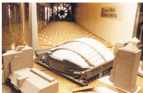
Rys. 7. Model stadionu sportowego z nietypowym ruchomym przekryciem (Sky Dome), wraz z sąsiadującą zabudową, do badań rozkładu ciśnień wiatru na przekryciu – tunel aerodynamiczny RWDI w Guelph (Ontario, Kanada)
