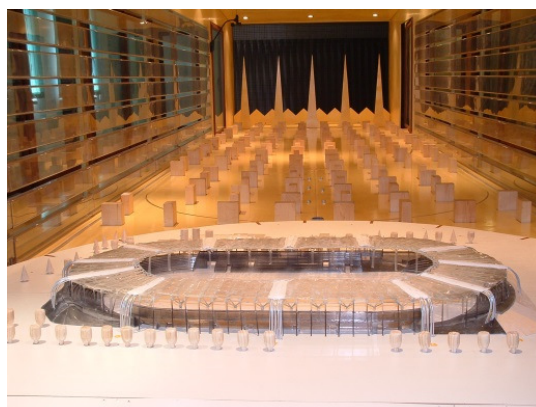
Model (1:200) zadaszania stadionu w Tarnowie w przestrzeni pomiarowej tunelu aerodynamicznego
