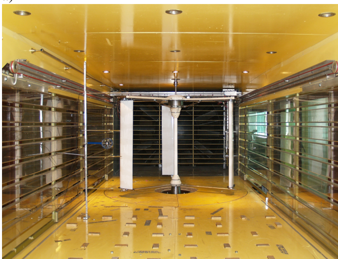
Widoki modeli turbin: o osi pionowej ze sterowanym ruchem łopat (a) i turbiny stożkowej o osi poziomej (b) w przestrzeni pomiarowej tunelu aerodynamicznego
