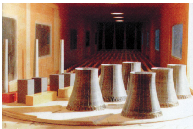
Rys. 8. Model chłodni kominowych i sąsiadującej zabudowy (budynki i kominy elektrociepłowni) do badań rozkładu ciśnień wiatru na ścianach chłodni, z uwzględnieniem zjawisk interferencji aerodynamicznej – tunel aerodynamiczny Uniwersytetu w Rio Grande do Sul (Brazylia)
