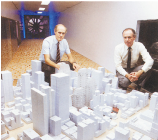
Rys. 6. Model zabudowy wielkomiejskiej wraz z modelem sztywnym wysokiego budynku do badań rozkładu ciśnień wiatru na ścianach budynku, z uwzględnieniem zjawisk interferencji aerodynamicznej, pochodzących od sąsiadującej zabudowy – tunel aerodynamiczny RWI w Guelph (Ontario, Kanada)
