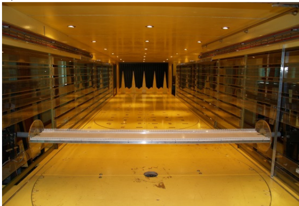
Model sekcyjny przęsła mostu bez (a) i z ekranami akustycznymi (b) umieszczony w przestrzeni pomiarowej tunelu aerodynamicznego
