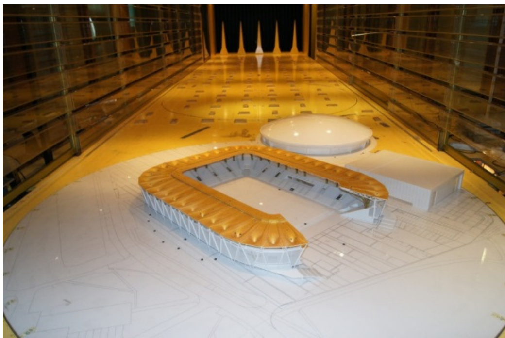
Widok modelu stadionu wraz z otoczeniem w przestrzeni pomiarowej tunelu aerodynamicznego
