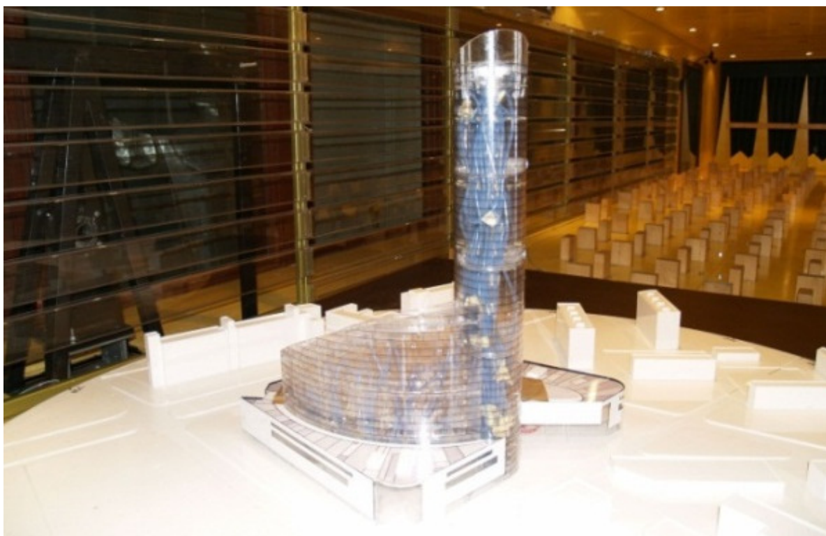
Widok modelu budynku Sky Tower wraz z otoczeniem, umieszczony w przestrzeni pomiarowej tunelu aerodynamicznego
