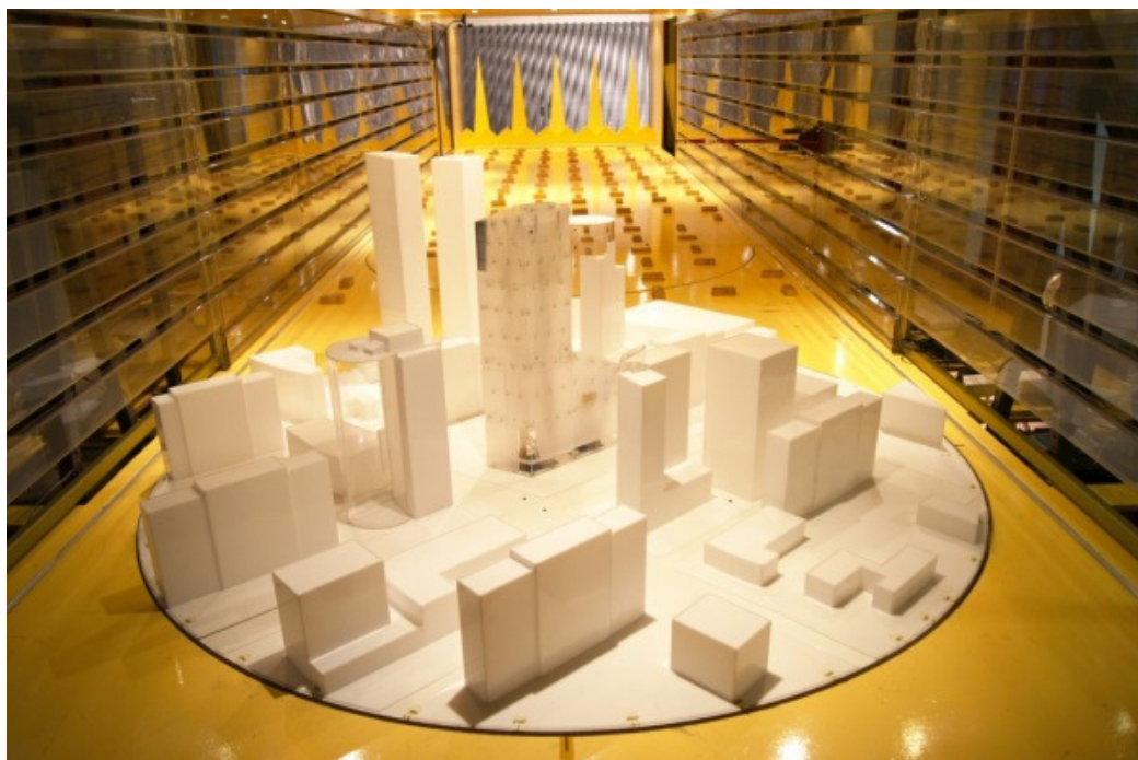
Model budynku wraz z otoczeniem interferencyjnym w przestrzeni pomiarowej tunelu aerodynamicznego
