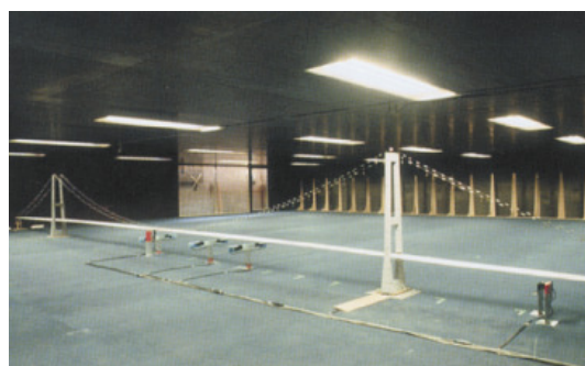
Rys. 9. Model aeroelastyczny głównego przęsła mostu wiszącego (Great Belt East Bridge) w tunelu aerodynamicznym im. Martina Jensena w DMI Lyngby (Dania)
